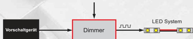
Es gibt ebenso Dimmer die bereits eine Steuerung integriert haben, welche sich entweder frei programmieren lassen oder häufiger bereits über eine gewisse Anzahl an fertigen Ablaufprogrammen (Szenen) verfügen. Die Programme lassen sich dann meist per Tasten am Gerät und/oder per Fernbedienung auswählen. Eine externe Steuerung ist in diesem Fall nicht nötig.
