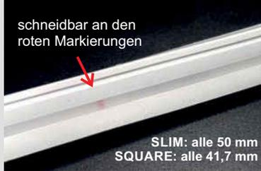
MiniFlex System nur im ausgerollten und „entspannten“ Zustand durchtrennen, ansonsten kann sich nach dem Trennen der LED Streifen aus der Hülle heraus schieben.
